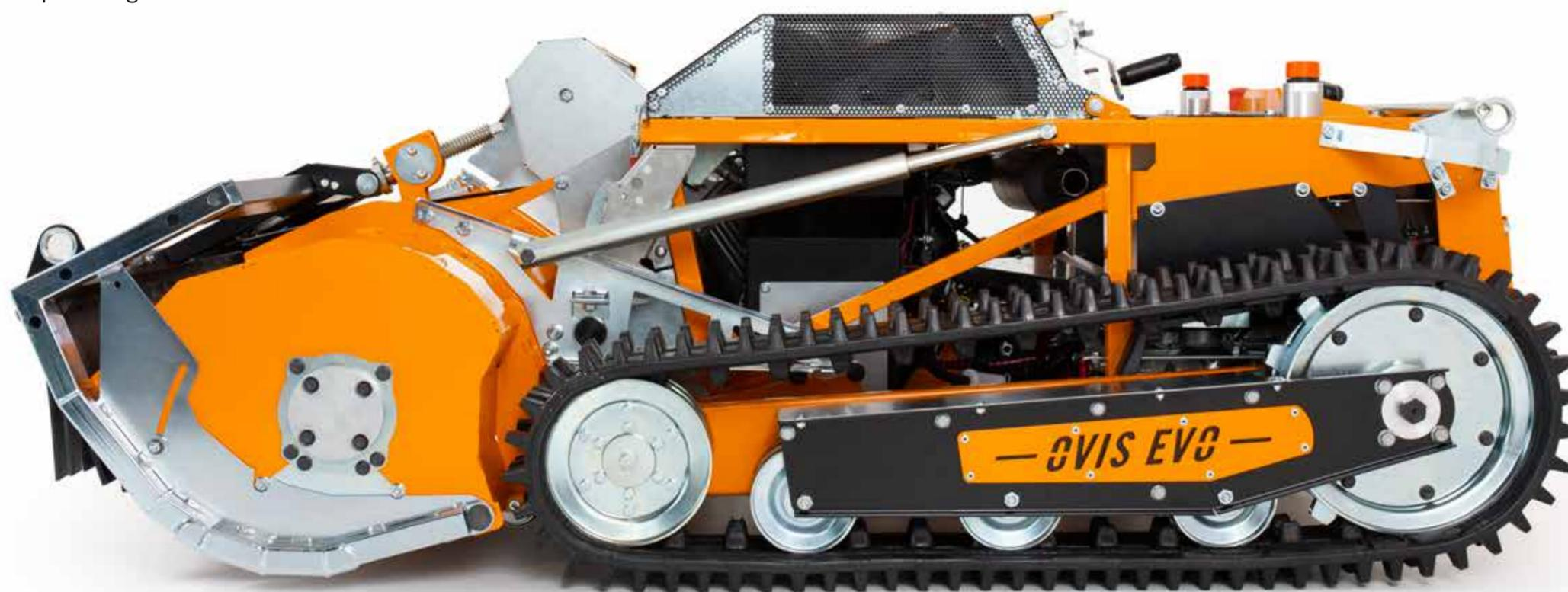
Der neue **AS 1000 OVIS EVO RC** unterscheidet sich zum Basismodell durch eine ferngesteuerte, elektrische Schnitthöhenverstellung mit Anzeige, eine fernsteuerbare, elektromechanische Messerkupplung und eine Schnellfreischaltung von Hydrostaten und Bremse.
