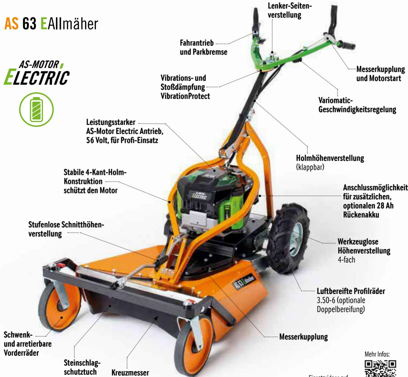
**Der neue AS 63 EAllmäher:** der wohl extremste Akku-Mäher der Welt. Gemacht für hohes Gras bis 100 cm. Maximal mögliche Hangtauglichkeit, Differentialsperre, automatische Park- und Motorbremse. Untersetzungsgetriebe mit stufenloser Geschwindigkeit. Optimales Gewicht und ausgewogene Balance. Angetrieben von einem bärenstarken Elektromotor und bestückt mit den leistungsstärksten, tragbaren Akkus. Die Grenzen der Maschine? Extrem!
